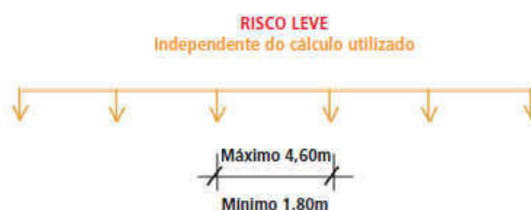
Distância máxima e mínima entre chuveiros automáticos
