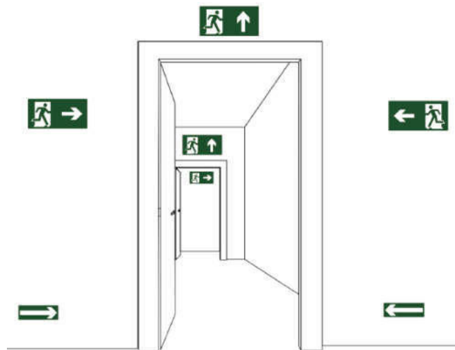
Figura 2 - Detalhe típico instalação sinalização sobre paredes e vergas de portas.
