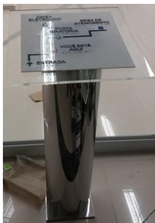
Suporte Metálico e Mapa tátil em acrílico
